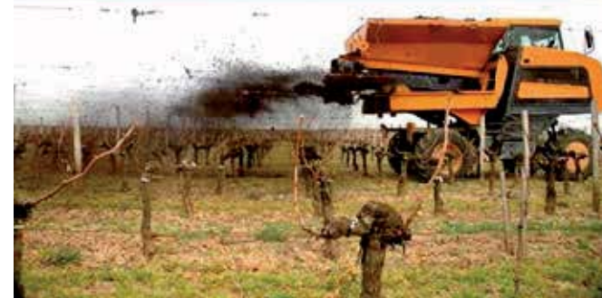
Obr.4: Rozmetací adaptéry pro hnojení organickými hnojivy na portálových nosičích
