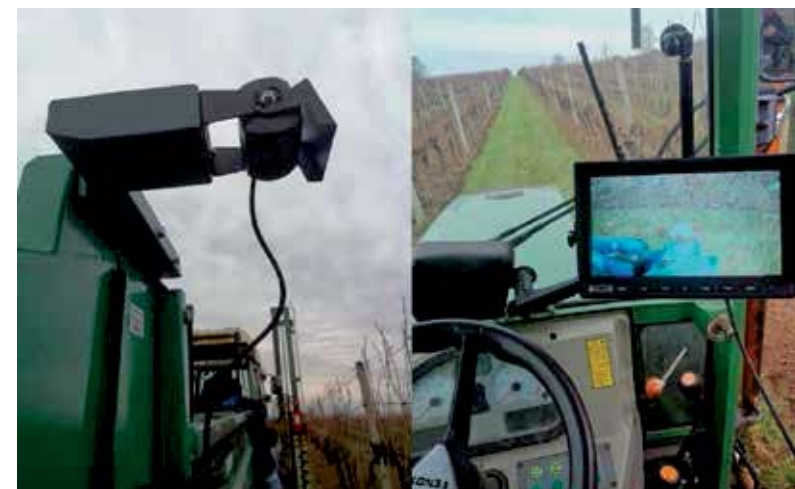
Obr.6: Monitorovací kamera umístěná nad aplikační koncovkou
