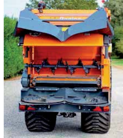
Obr.3: Traktorové rozmetadlo s dvěma rozmetacími talíři
