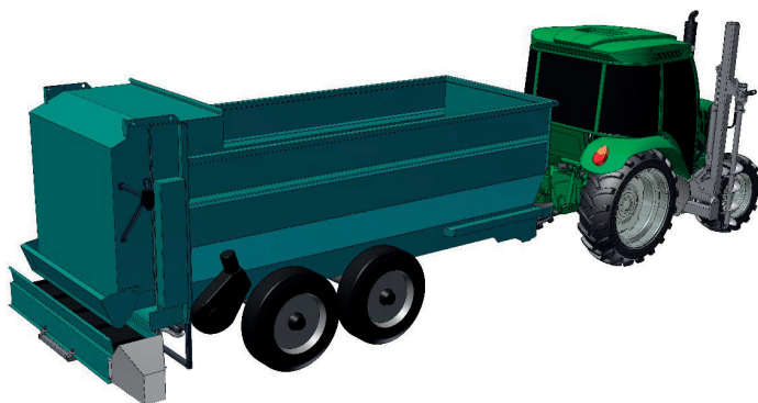
Obr. 1 Zařízení pro bodovou aplikaci organické hmoty
